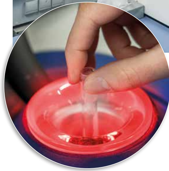
Het nieuwe laboratorium van Veritas waar een vastvetanalyse wordt verricht met benchtop-NMR. Via het scherm worden de te doorlopen stappen getoond.
