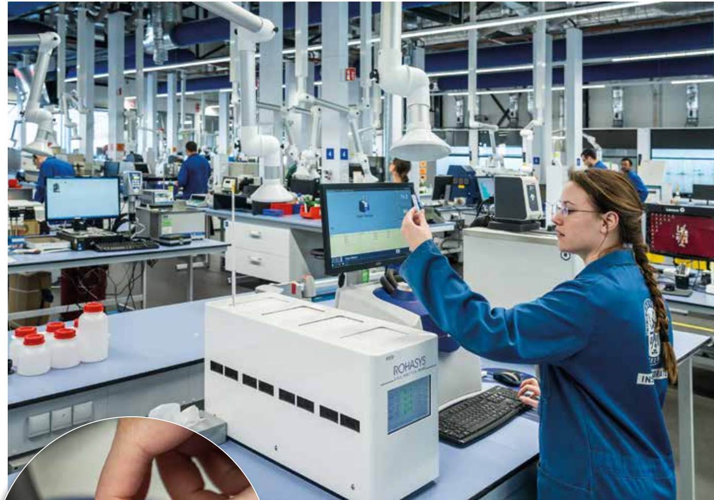
Het nieuwe laboratorium van Veritas waar een vastvetanalyse wordt verricht met benchtop-NMR. Via het scherm worden de te doorlopen stappen getoond.
