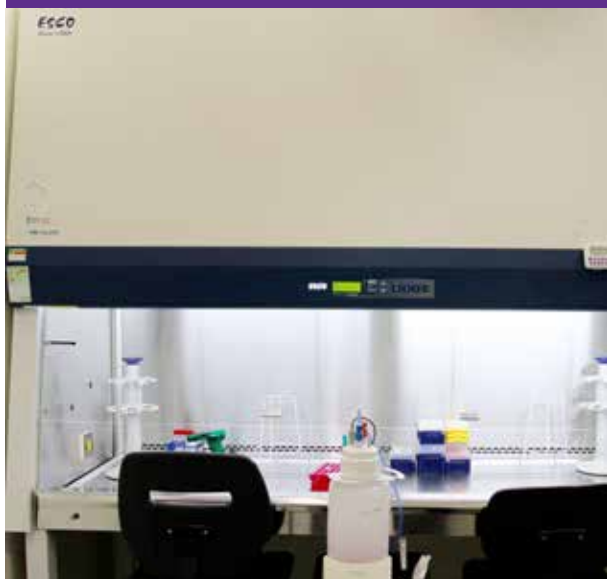
De Esco klasse II bioveiligheidskasten zijn geschikt voor het werken met virussen in ML-II laboratoria.
