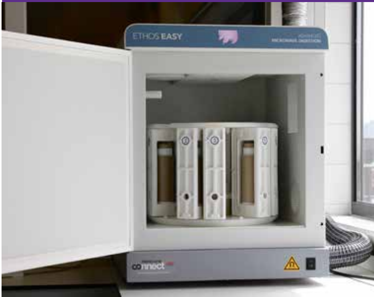
Met de door Salm en Kipp geleverde Ethos Easy microwave van Milestone worden monsters voor ICP-analyse beter ontsloten dan met de volgens IP-501 voorgeschreven verassing.
