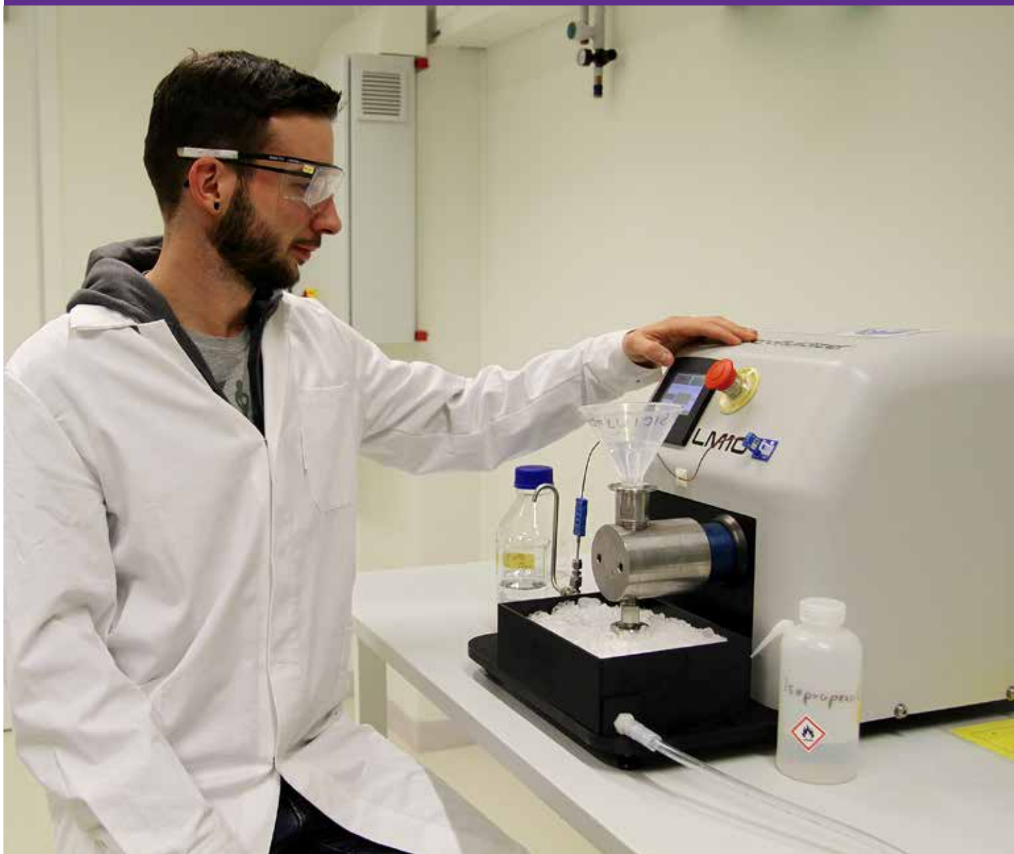
PhD-student Sebastian Kiehstaller maakt voor de eerste stap in het opzuiveringsproces van eiwitten, die tot expressie zijn gebracht in E. coli , gebruik van de LM10 microfluidizer van Microfluidics, die is geleverd door Salm en Kipp. Hiermee kunnen betrouwbaar en snel de eiwitten worden vrijgemaakt uit de celsuspensie.
