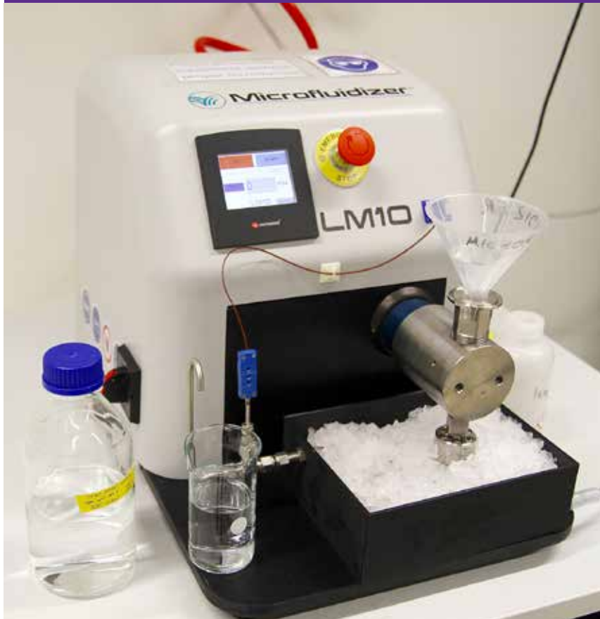
De LM10 microfluidizer van Microfluidics drukt een celsuspensie door een shearing cell, een keramische unit, die steeds nauwer wordt en op een gegeven moment de cel kapotmaakt. Vervolgens gaat het lysaat, met de eiwitten erin, door een gedeelte dat heel efficiënt koelt.
