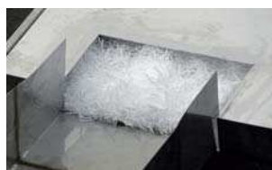
Filtratie van het afvalwater alvorens het wordt afgevoerd naar het afwateringsgebied.
