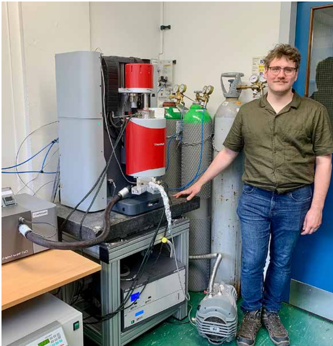
Senior onderzoeker Gerben van Straaten in het laboratorium van Carbyon bij de door Salm en Kipp geleverde Themys van Setaram, een analyse-instrument voor TGA. Onderaan de opstelling is de massaspectrometer te zien; links de luchtvochtigheidsgenerator.
